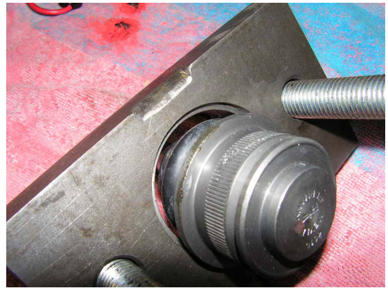
Platte zum Einpressen Stufenbohrung passend zum Gelenk.
