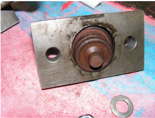
Platte zum Auspressen Durchmesser größer wie das Gelenk.
