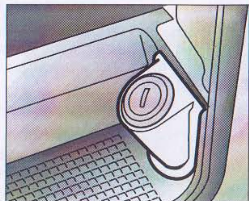
Bild 26 Einfüllstutzen für Frischwasser.
