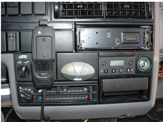
Anbringen des Bedienteils mittels Doppelklebeband. Leider ist es weder besonders schön, noch von der Form her wirklich gut zu integrieren. Spätziel ist es deshalb, möglichst den original T4 Lenkstockscharter mit Tempomattasten nachzurüsten.
