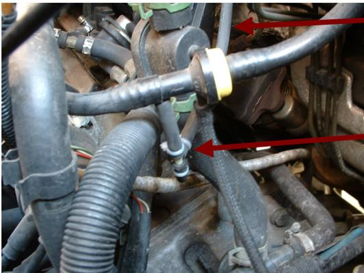
Unterdruckschlauch zum Servo.
