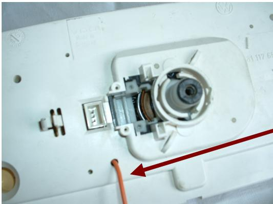
KI mit ausgebrochener Abdeckung an der Tachowellenaufnahme.
